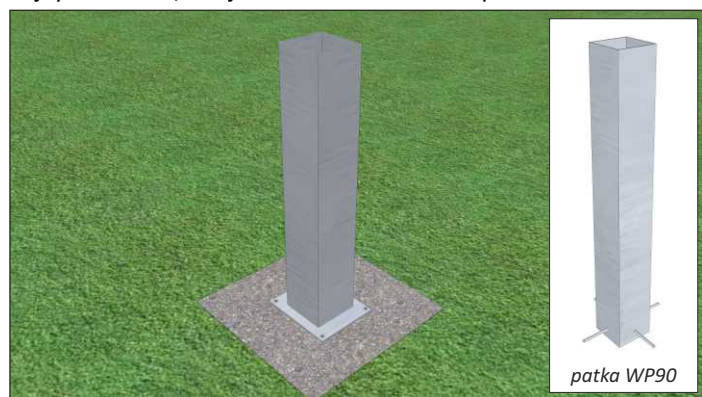
Montáž patky na betonový základ
