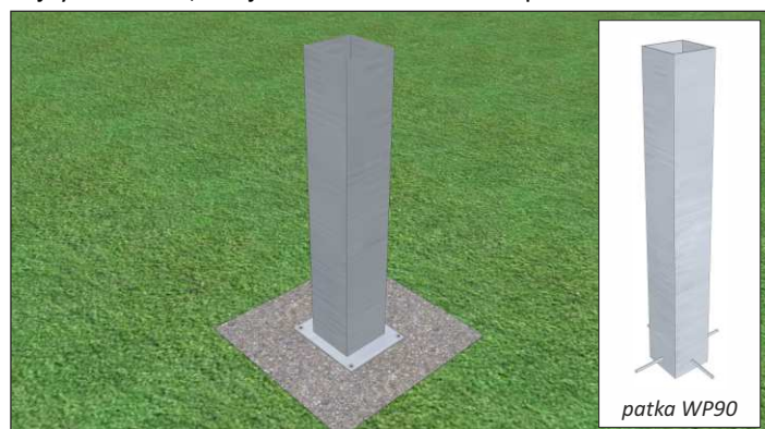
Montáž patky na betonový základ
